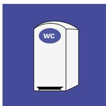
**Cabine sanitaire mobile autonome<sup>1</sup> (toilettes autonomes)** : elle ne nécessite aucun raccordement aux réseaux (en eau et/ou en électricité). Elle peut intégrer un urinoir et un lave-main. Elle nécessite des services d'hygiène associés (nettoyage, vidange, désinfection, consommables tels que savon, papiers toilettes essuie main...), a minima hebdomadaires.
