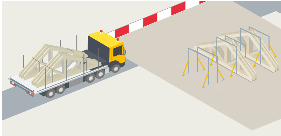
▲ Figure 16 – Livraison et stockage de fermettes
