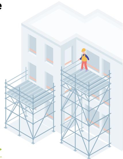
Figure 11 – Équipement avec une barrière écluse ►
