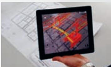
6 **Bloc In Bloc** : module d'interaction de réalité augmentée multicouche dédié à la valorisation d'une maquette BIM, disponible sur smartphones et tablettes.
