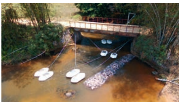
Le système permet de fournir de l'électricité à des sites isolés, comme c'est le cas ici dans un village du Congo.
