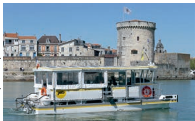
Depuis 1998, les passeurs de mer de La Rochelle sont équipés de panneaux électrosolaires.
