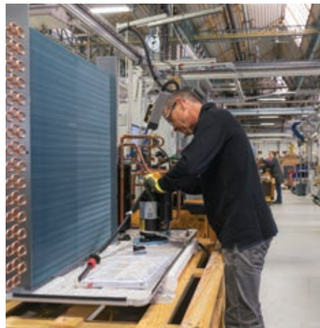
Cette toute nouvelle ligne de production sur le site de Nantes a fait l'objet de toutes les attentions pour proposer un assemblage d'une exigence extrême en termes de qualité. Trois heures s'écoulent entre l'arrivée des premières pièces et l'emballage de la PAC en fin de ligne.
