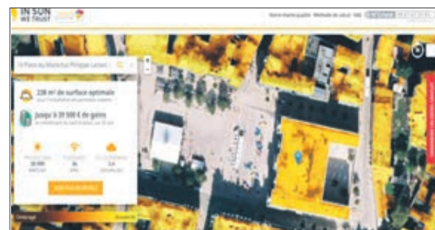
Selon le cadastre, les 238 m 2 de surface optimale de la toiture de la mairie de Poitiers produiraient 38 000 kWh/an.
