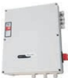
Le coffret Ordiny's® Park pilote les ventilateurs de désenfumage dans les parkings d'habitat collectif. Il offre deux vitesses de ventilation, programmables sur l'horloge intégrée, pour une gestion appropriée au trafic, notamment aux heures de pointe. Sa vitesse de ventilation s'adapte au niveau de pollution dans le parking : si celui-ci est élevé, Ordiny's Park passe automatiquement en mode grande vitesse.
