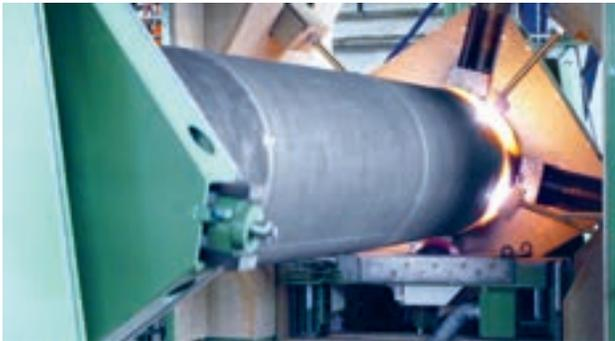
Impressionnant, ce poste permet de canneler les corps de chauffe des chaudières en les faisant tourner autour de brûleurs à plus de 1 000°C. L'opération peut durer plusieurs heures.
