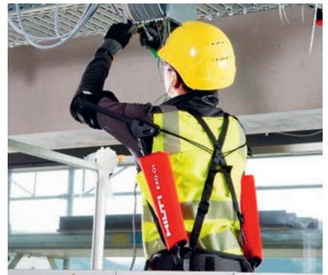
Grâce à cet exosquelette Exo-O1 (sortie prévue début 2021), les pics de contrainte exercés sur les muscles devraient être réduits jusqu'à 47 %.
